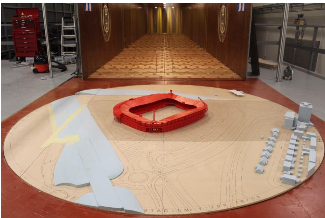
Figuur 4-11 Schaalmodel AFAS-stadion zonder doeken
