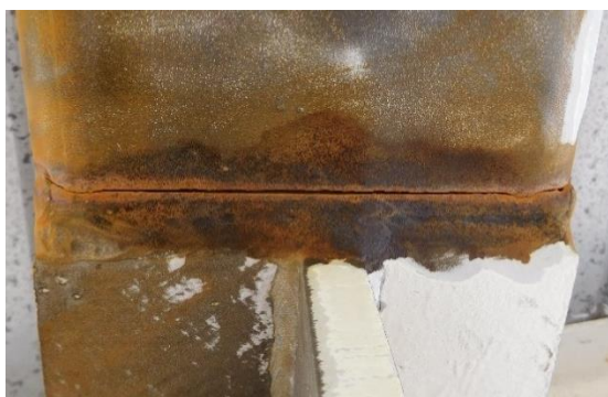
Figuur 4-19 Scheur in las 43 – 1/2 – C
